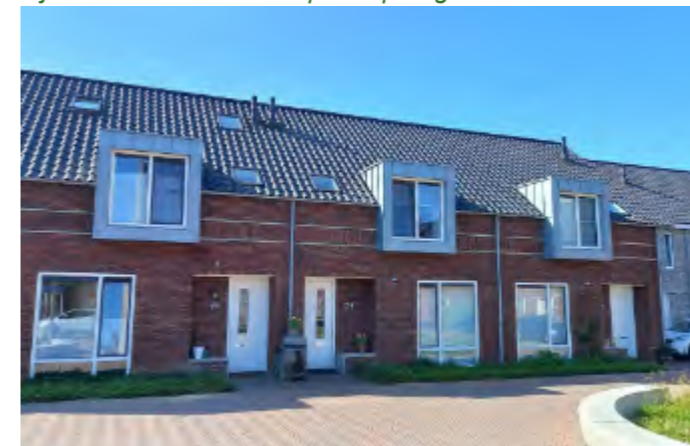
Eén of anderhalve laag met kap. Deel van gevel doorgetrokken in kap. Verbijzonderingen.
